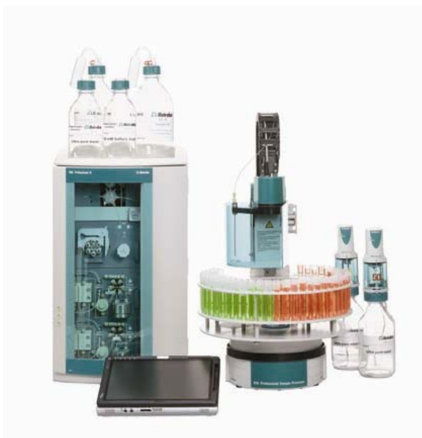
شکل ۱- نمایی از دستگاه کروماتوگرافی یونی حرفه‌ای مدل 850 ساخت کمپانی Metrohm سوئیس
